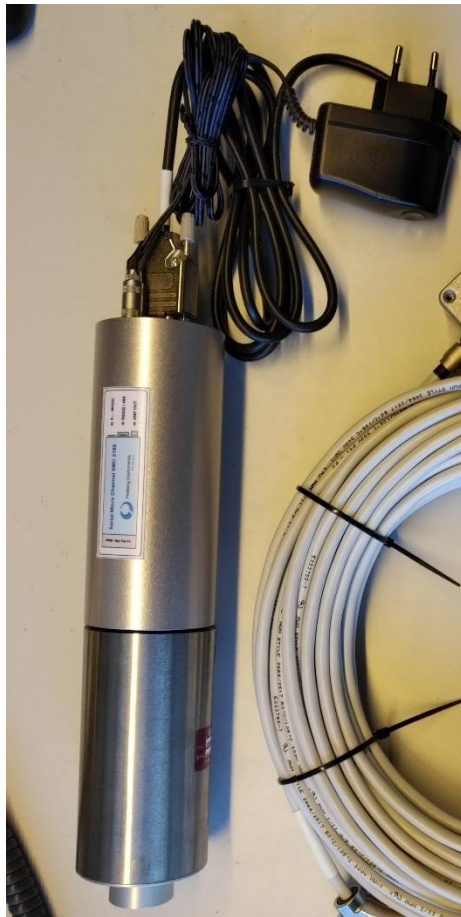
Abbildung 14: CLYC Neutron-Szintillator-Detektor mit Vorverstärker [22].
