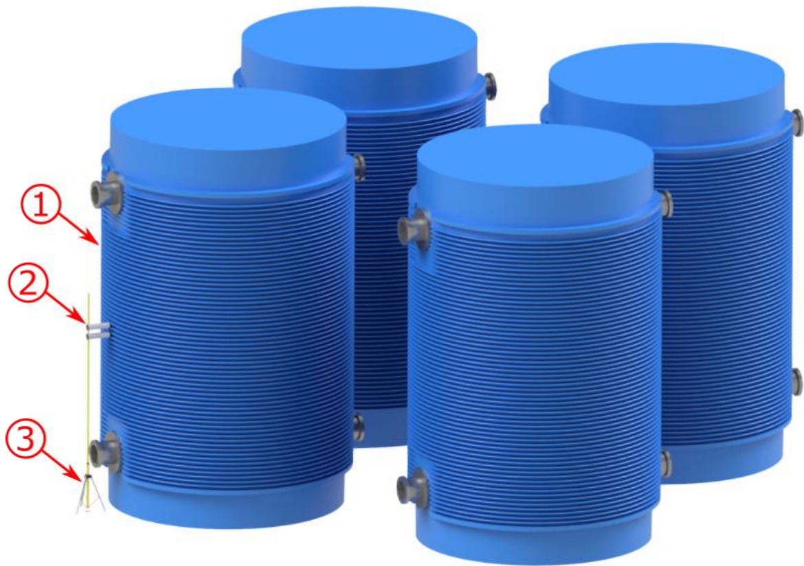
Abbildung 70: Gerendertes CAD-Modell des Messaufbaus mit CASTOR 440/84 (1), CLYC-Sensoren (2) und Stativ (3) im Verbund
