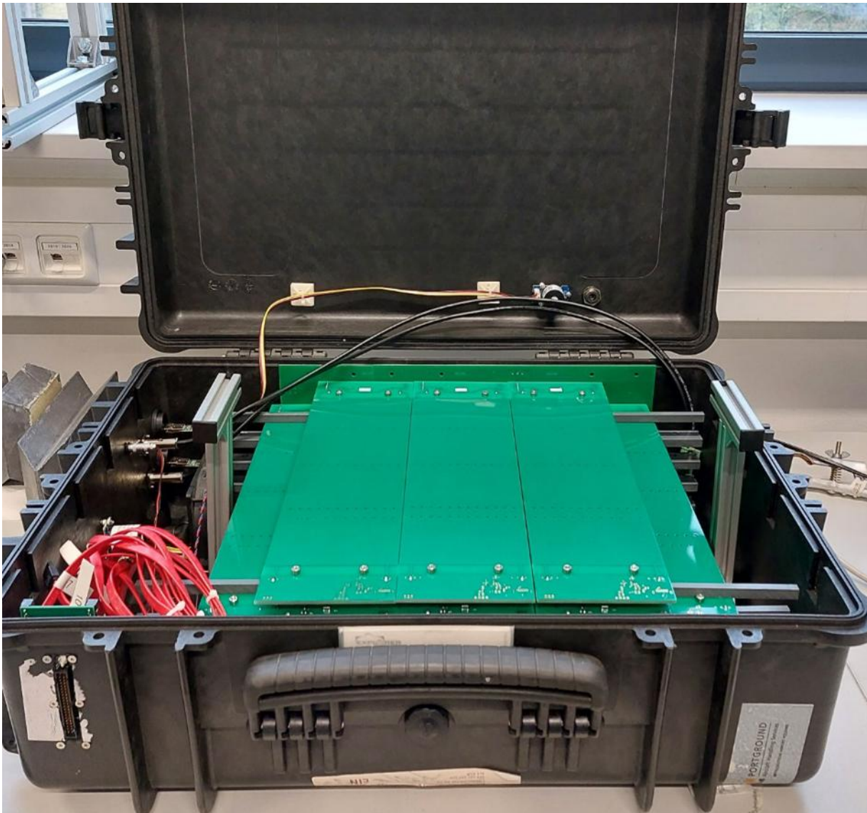
Abbildung 31. Foto des Myonendetektor-Prototyps, bestehend aus 17 Driftkammern, die in fünf horizontalen Lagen angeordnet sind. Das Driftkammergestell ist in ein gasdicht verschließbares Gehäuse integriert.
