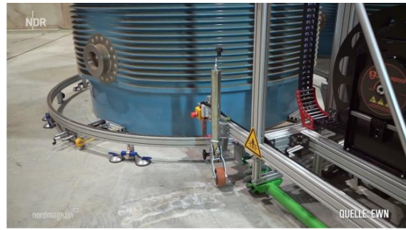
Abbildung 40: Oberer Teil des Messsystems mit Szintillationsdetektor während der Messung am Behälter im Lagerverbund (links) und unterer Teil des Messsystems mit Schienenführung (rechts) als Screenshots aus dem NDR-Beitrag über die Messungen im Zwischenlager [33].
