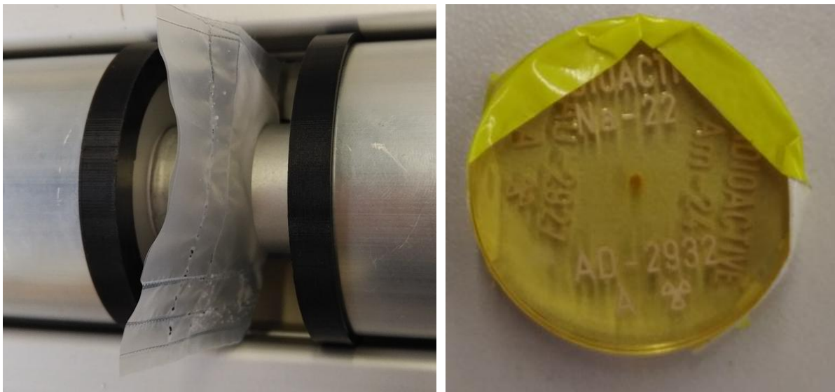
Abbildung 58: V1 - Probestrahler: aktiviertes Kochsalz (links) und Na-22 (rechts)
