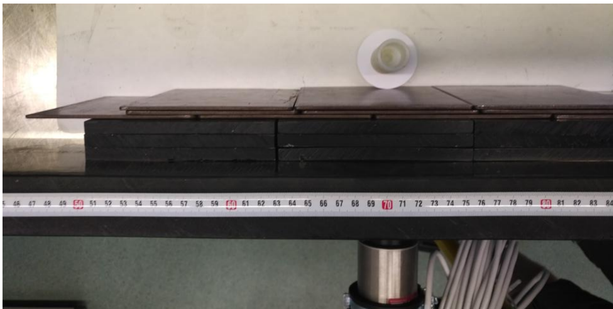
Abbildung 65: V4 - Messaufbau zur Erfassung von GN-Strahlung entlang einer Barriere
